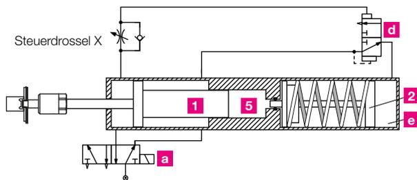
**Krafthub** – der Übersetzerkolben **2** schließt die Hochdruckkammer **5** und verdichtet das Öl im Arbeitsbereich auf bis zu 400 bar. Dieser Öldruck wirkt auf die Rückseite des Arbeitskolbens **1** und löst den Krafthub aus.
