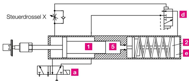
**Eilhub** – das Hauptsteuerventil **a** wird betätigt. Der Arbeitskolben **1** fährt im Eilhub aus, bis er an beliebiger Stelle auf eine Gegenkraft stößt. Er hält an und das eingebaute Krafthubventil **d** schaltet um. Luft strömt in Raum **e**.
