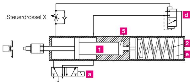
**Rückhub** – nach Umschalten des Hauptsteuerventiles **a** entlüftet das Krafthubventil **d** den Raum **e** automatisch. Übersetzerkolben **2** und Arbeitskolben **1** fahren nacheinander in Ausgangsposition zurück.
